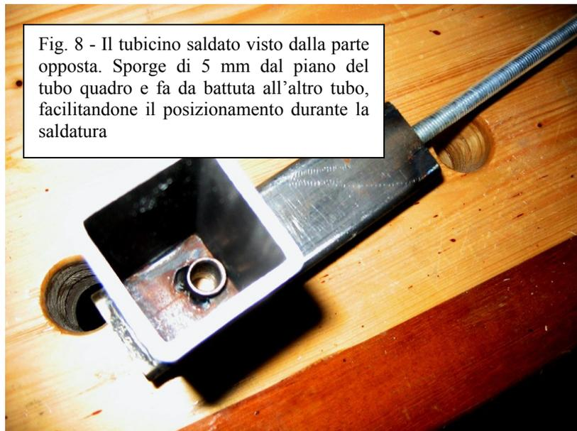
Fig. 8 - Il tubicino saldato visto dalla parte opposta. Sporge di 5 mm dal piano del tubo quadro e fa da battuta all'altro tubo, facilitandone il posizionamento durante la saldatura
