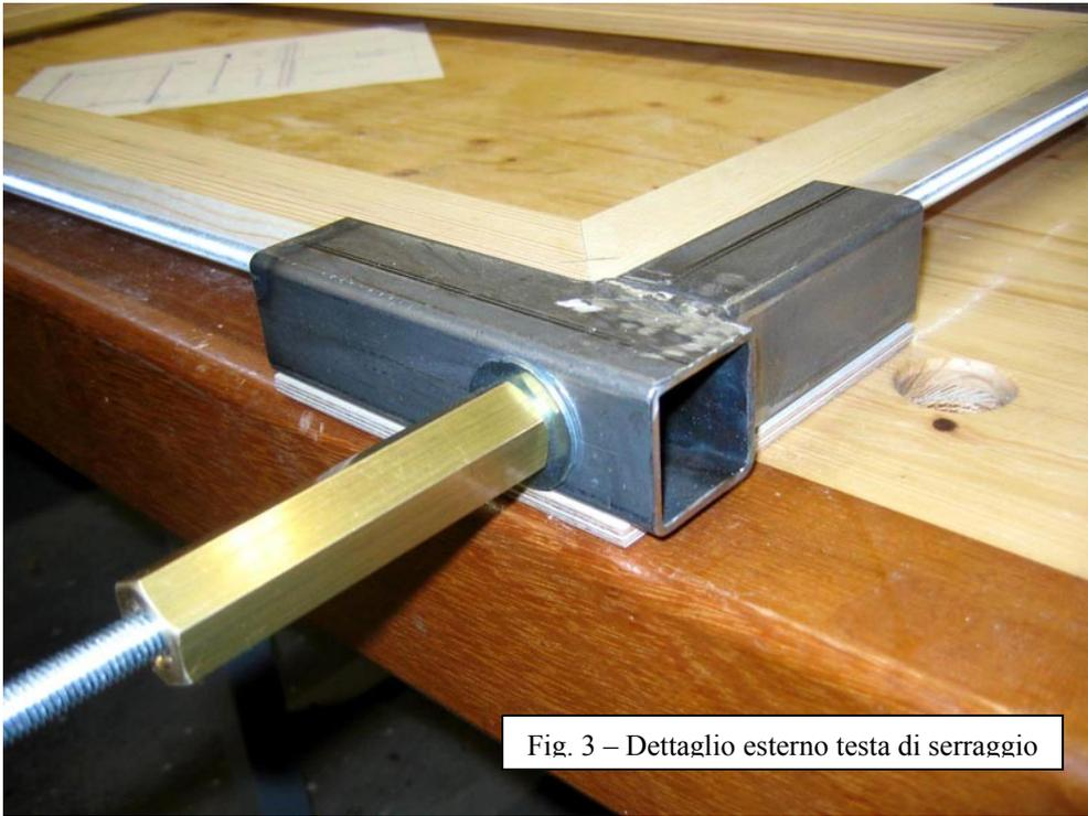
Fig. 3 – Dettaglio esterno testa di serraggio
